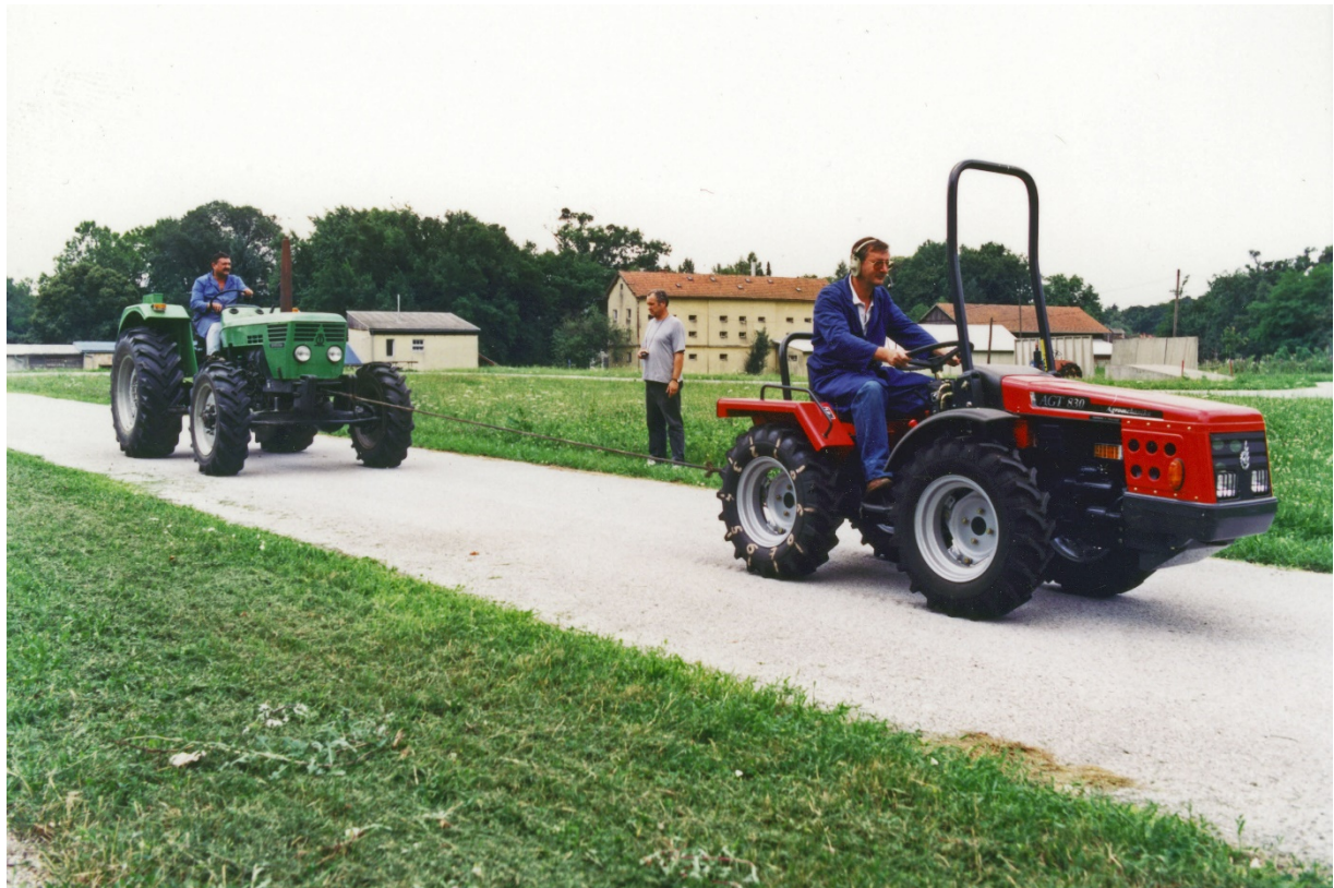
Slika 26. Ispitivanje vučnih karakteristika traktora na asfaltnoj pisti znanstveno-nastavnog poligona '90-ih
