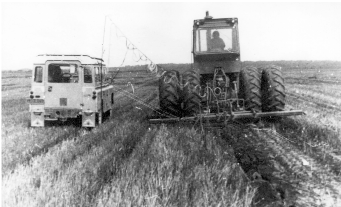
Slika 20. Provedba mjerenja otpora oruđa. Foto I. Antončić
