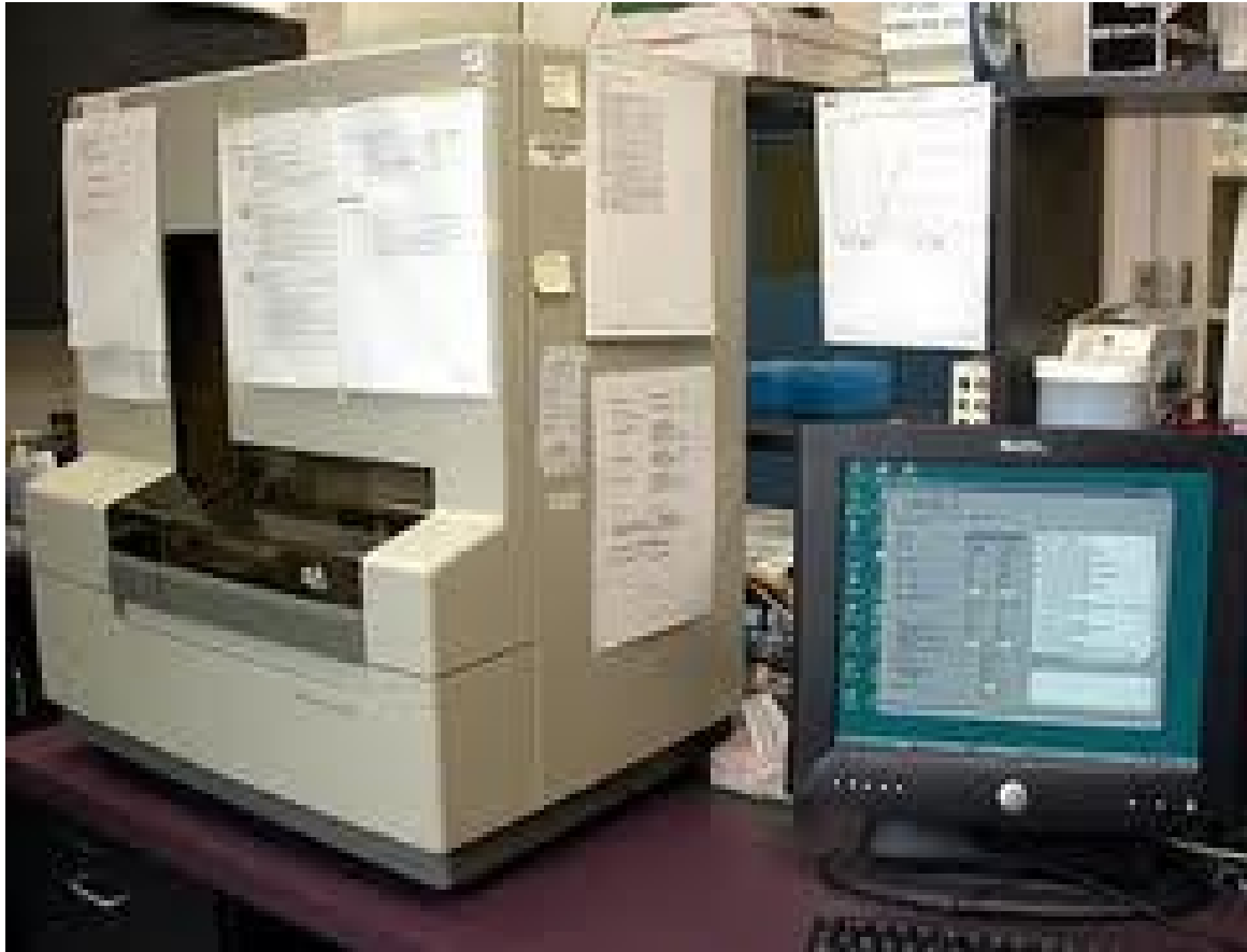
Slika 18. Aparat kapilarne elektroforeze za određivanje slijeda nukleotida
