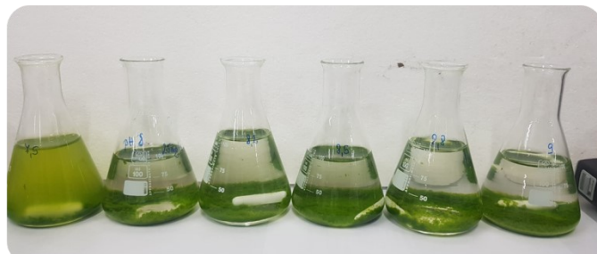
Slika 10. Flokulacija Picochlorum sp. hitozanom
